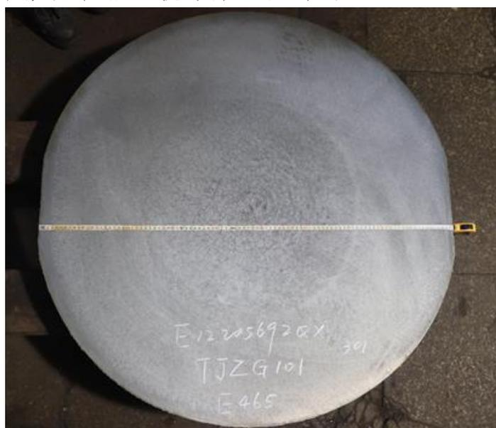
图 10 盾构机主轴承用  $\Phi 1200\text{mm}$  连铸圆坯的低倍图片
