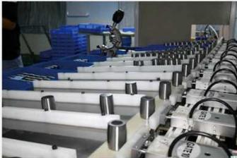
6、滚子采用冷锻或者热锻技术，最大限度保证了滚子的金属流线。以研磨替代平面磨，全线高精度数控磨床，以超精替代光饰，形位公差比国家2级滚子提升50%以上；采用全自动检验和分组设备，分组差确保2um以内，已联合申报球面滚子行业标准，并提出1级球面滚子相关指标。
