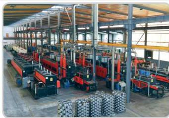
5、所有产品（包括滚子）采用可控气氛托辊盐浴热处理，实现0脱碳，淬透性强、硬度内外均匀；颜色均匀，形成的致密压应力层可提高产品30%以上使用寿命。每批式样采用破坏性试验，运用国际先进的蔡司（奥林巴斯）金相显微镜进行比对，所有试样样块均留样5年以上。公司参与制定了《GB/T34891-2017滚动轴承 高碳铬轴承钢零件 热处理技术条件》国家标准。
