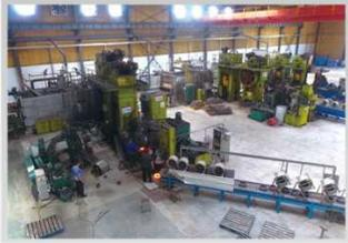
2、锻造采用精密仿形锻造，确保金属的连续封闭型流线和组织。采用蓄热式天然气燃烧系统炉减少脱碳现象；温控系统自动温度控制并记录，确保金属组织均匀；锻后喷雾冷却系统，有效细化金属组织晶粒，消除网状碳化物等组织缺陷，为后续球化退火打下良好基础。
