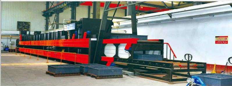
3、退火采用可控气氛托辊球化退火炉，硬度均匀，球化效果稳定，有效控制脱碳，外部无氧化硬层便于车削，摒除了普通球化退火炉硬度不均匀，氧化层大的缺点。
