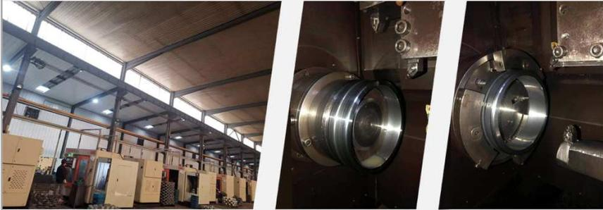
4、车加工采用公司发明专利夹具（自动定心均压装夹车加工夹具），该夹具能根据工件的自身椭圆、三角变形自动吊坠压力，校对工件中心，使工件轴心与转轴轴心同心，有效的提高了工件的加工速度，保证了产品的质量，提高了产品合格率。
